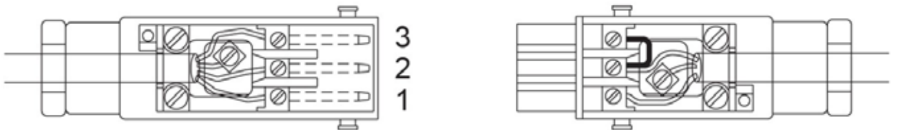
Schaltbild SunTop/Z M-868 RH 230 V / 50 Hz und Kabelbelegung bei Verwendung mit Hirschmann-Steckverbindung STAS-3 (mit Brücke)
